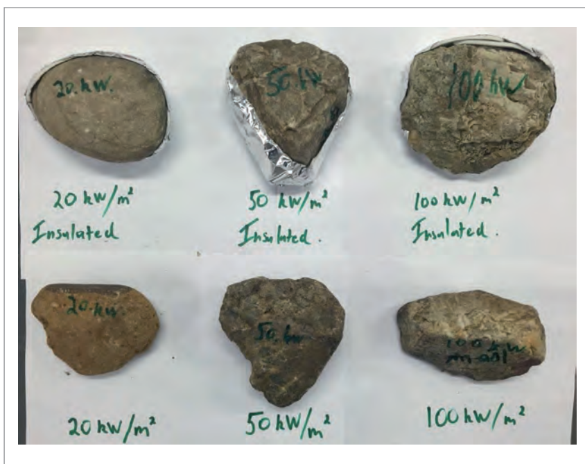
Figura 25. Rocas ensayadas antes de ser calentadas (22 de julio, 2015). Nótese el color amarillento de las rocas y el aislante térmico en la parte inferior de las rocas denominadas “Insulated”.
